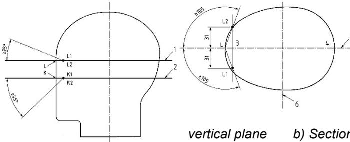
a) Schnitt des Prüfkopfes in vertikaler Längsebene
